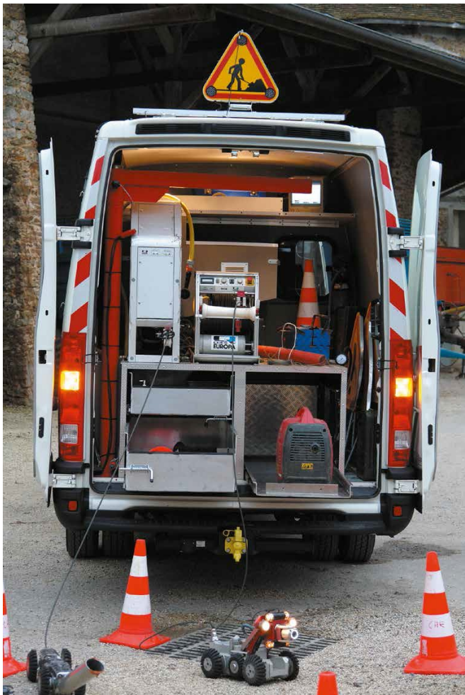
Camionnette d'inspection vidéo.
