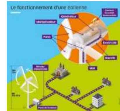
Illustration 100 : Schéma de fonctionnement d'une éolienne
