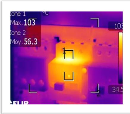
Cette technique de contrôle non destructif réalisée sur vos installations en service, nous permet de détecter les anomalies et les échauffements anormaux (mauvaises connexions, surcharges, déséquilibre de phases, contacts défectueux, sous calibre...) et ainsi, de prévoir les interventions correctives et les éventuels travaux.
